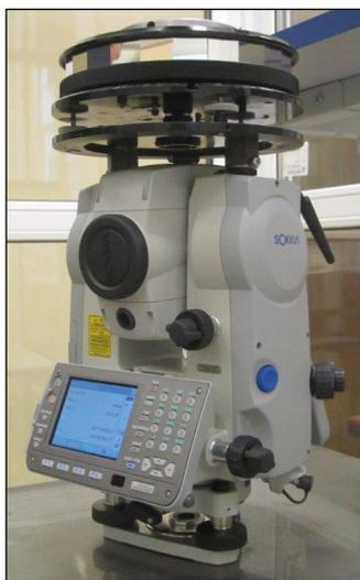
Рис. 3. Комплекс углоизмерительный
